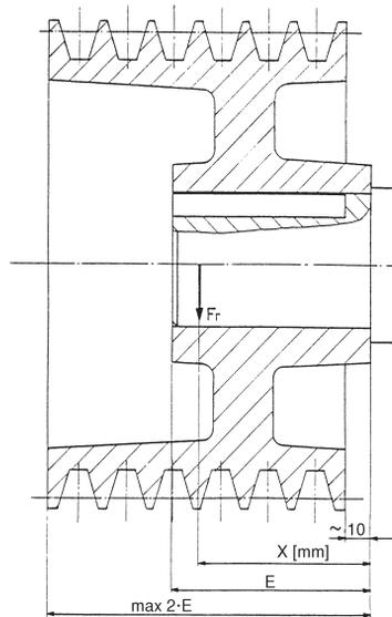
Carico radiale ammissibile per una durata teorica del cuscinetto lato accoppiamento di 20.000 ore.
