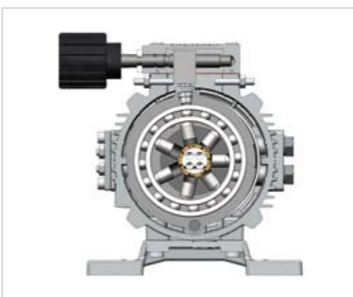
La regolazione della velocità si effettua variando l'eccentricità dell'unità primaria e di conseguenza la portata del fluido inviato all'unità secondaria. Questa, accoppiata all'albero di uscita, trasmetterà una velocità in giri proporzionale alla portata ricevuta. Alla massima eccentricità dell'unità primaria, corrisponderà la massima velocità dell'albero di uscita e ad una minore eccentricità corrisponderà una minore velocità. Con eccentricità nulla si avranno zero giri all'albero di uscita.
